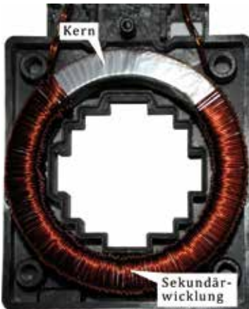
Abb. 2 Offener Aufsteck-Stromwandler nach Abb. 1/S. 6 mit Kern und Sekundärwicklung
